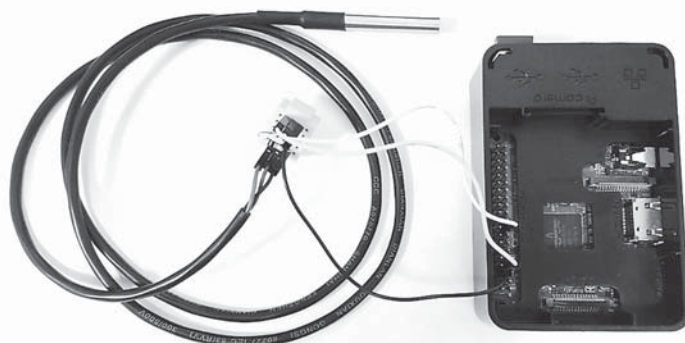
図 1. 防水型温度センサを取り付けた、自記型温度測定教材
