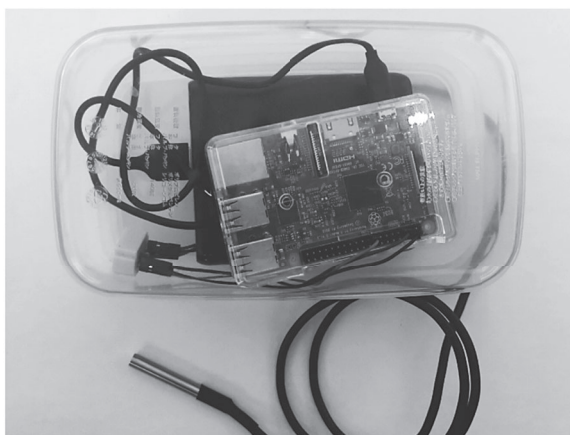
図 6. 気温測定教材、黒いコードの先端が温度センサーである
