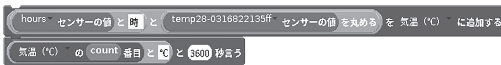
図1. 気温を測定しリストに記録し、スプライトに表示するブロック例
